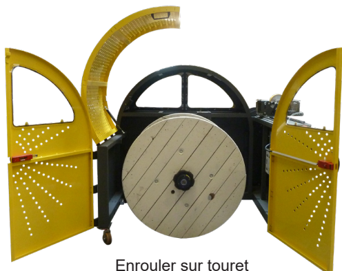
Enrouler sur touret (maxi 400kg et Ø 1050mm)
